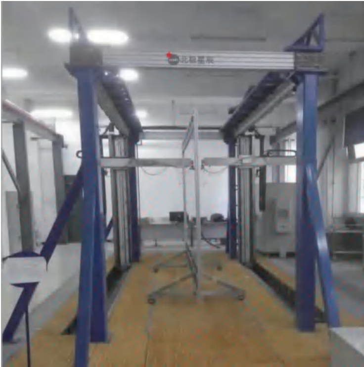
十轴（左5轴、右5轴）左右喷水 检测范围：长6000*高2000
