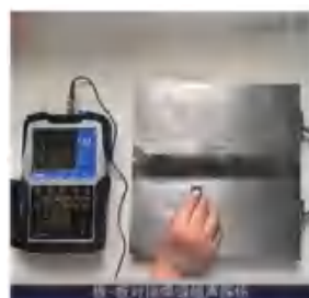
板-板对接焊缝超声探伤
